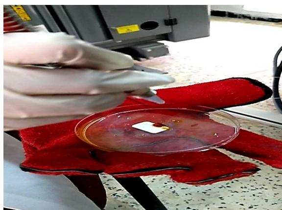
**Figure 25** : Déshydratation des extraits bruts et des phases à l'aide de l'azote gazeux
